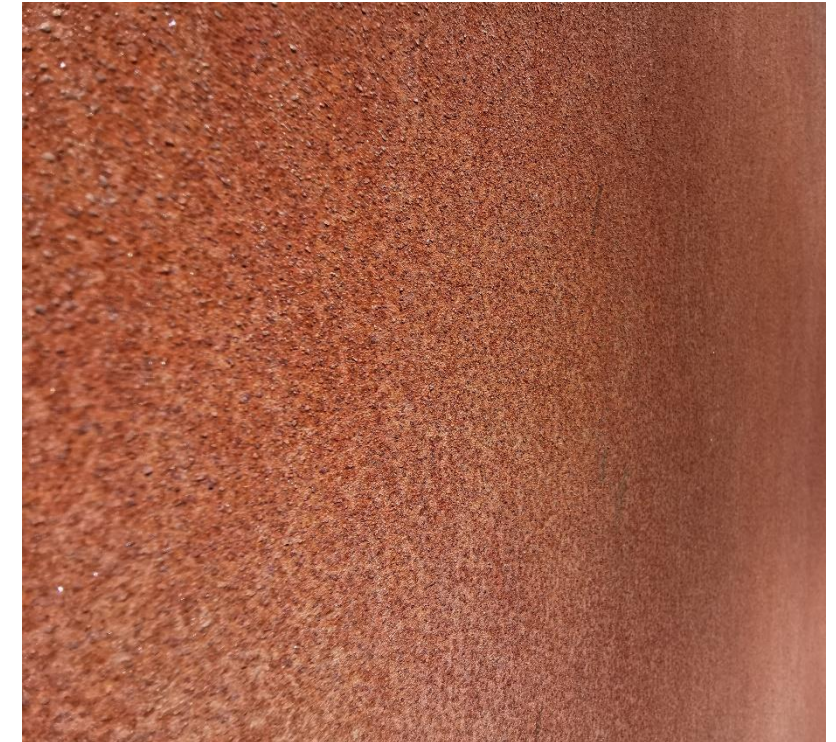
Вид поверхности вблизи при экспонировании в открытой промышленной атмосфере в течение 25 мес.
