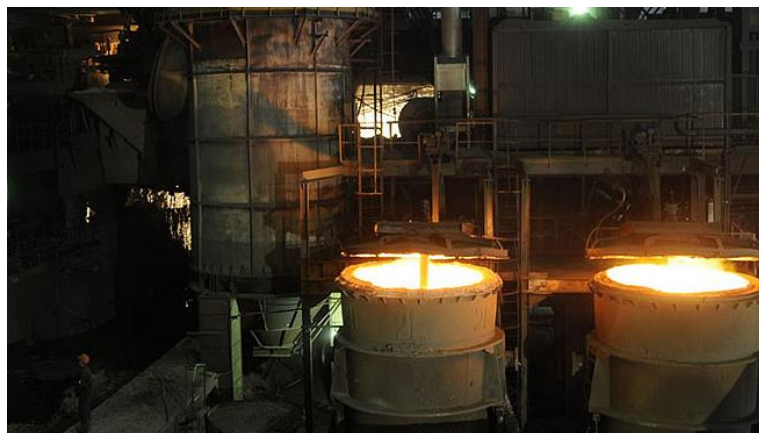
Печь-ковш для рафинирования и долегирования стали
