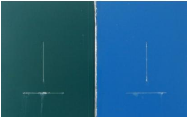
Rooftop Шелк после 500ч испытаний в камере соляного тумана
