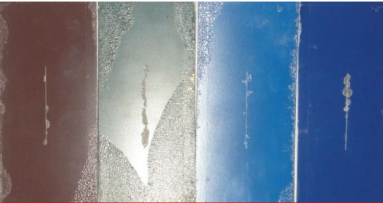
Пример образцов импортных производителей после 360 ч. Испытаний в камере соляного тумана
