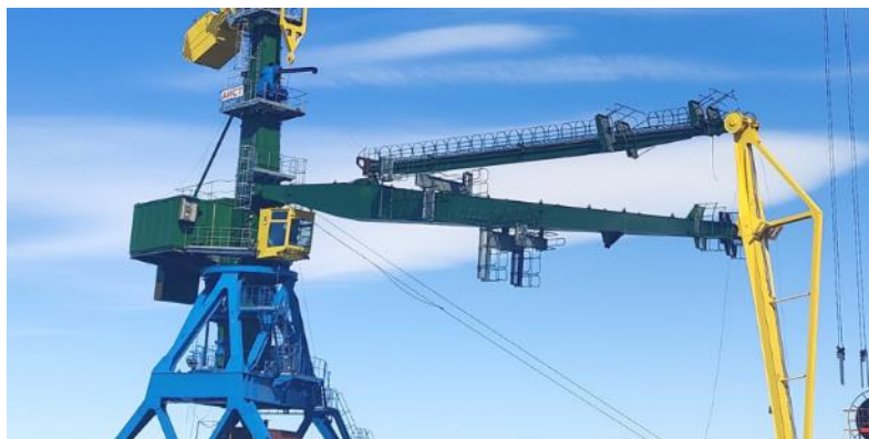
Элементы порталных кранов: кабина, механизм подъема и передвижения, поворотная платформа, система шарниров и блоков, стрела
